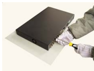
8) Зафиксируйте крышку винтами
