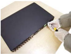
1) Открутите винты, фиксирующие крышку
