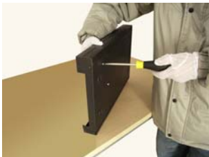
4) Зафиксируйте диск винтами
