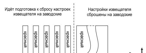
Рис.7.3. Режим аппаратного сброса настроек
